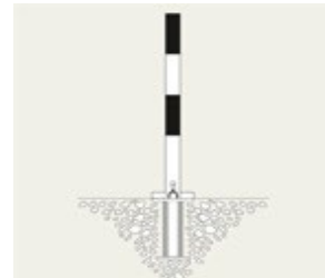
zum Einbetonieren: Pfostenlänge: 1330 mm davon 330 mm Unterflur
