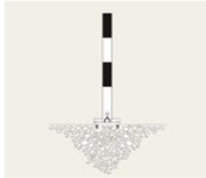
zum Aufdübeln: Pfostenlänge: 1000 mm (Lieferung ohne Befestigungsmaterial)
