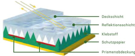
Die Weiterentwicklung der bereits in die Jahre gekommenen Engineer Grade Glasperlenfolie bietet eine bessere Tages- und Nachtsichtbarkeit durch ihre hellere Oberfläche und hat alle Vorteile einer mikrop Prismatischen Folie. Die Reflektion ist höher als bei Engineer Grade (EG), und niedriger als bei High Intensity Prismatic (HIP) - daher kann sie die Folie Type II nicht ersetzen.
